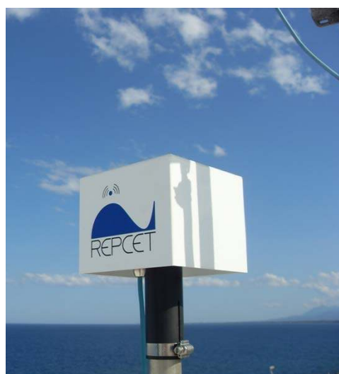
Figure 1. Antenne Iridium / GPS et modem Iridium placés dans un boîtier étanche rectangulaire.
